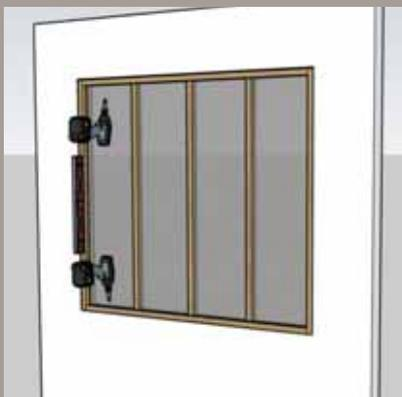
**2/** Visser la verrière dans la cloison en utilisant la visserie adaptée au support (non fournie)
